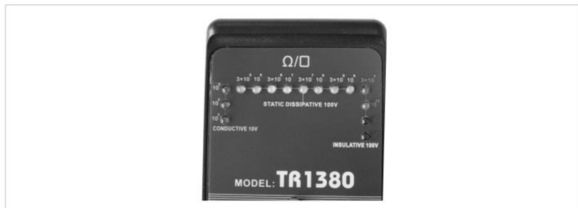
测试结果会通过LED显示，为了使测量数据更接近事实，设计上使用了 half decade 的显示方式。A decade会照亮相应的测试结果，用颜色标出测试值的功能。
