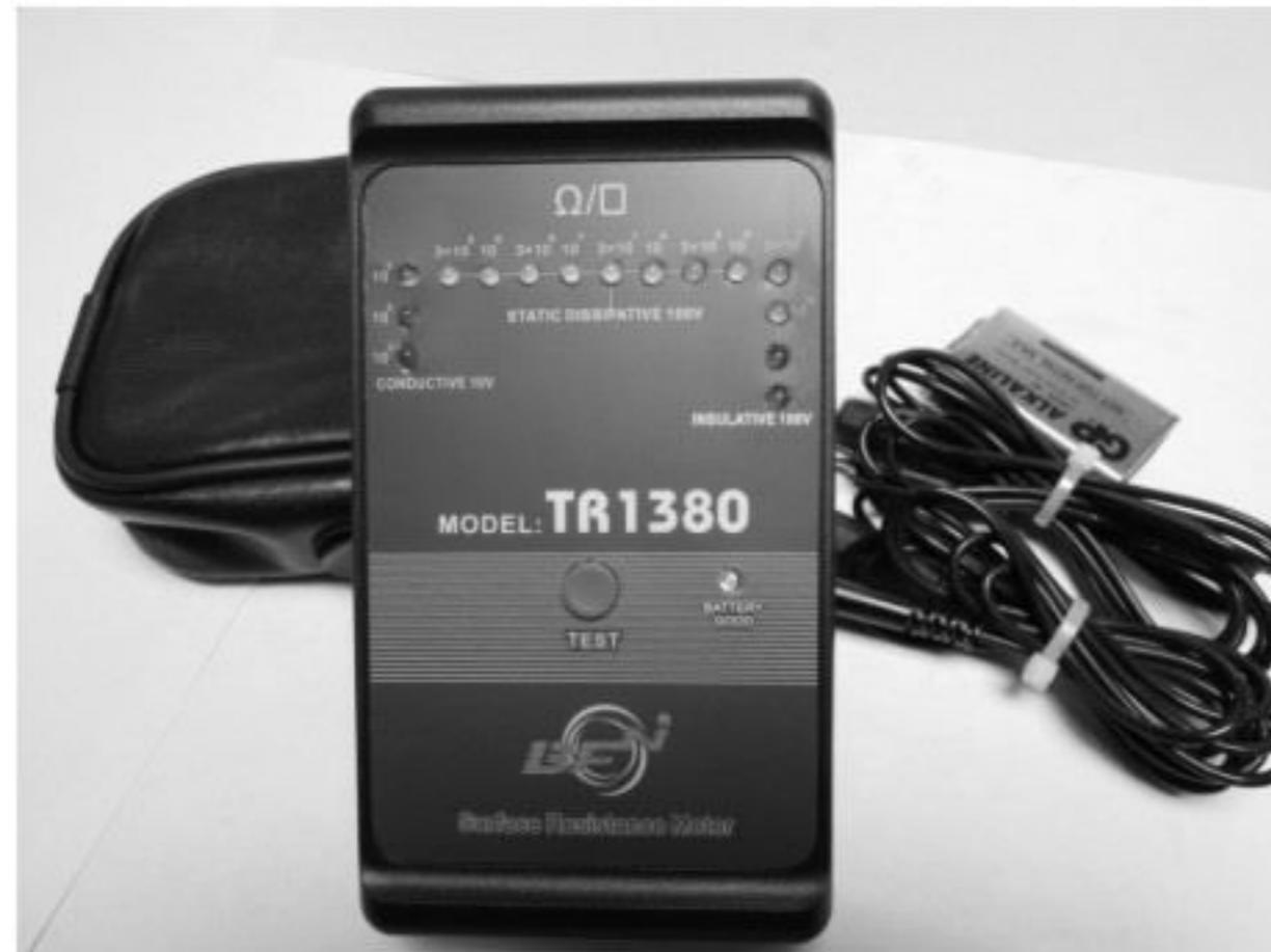
TR1380是一款轻便易携的自动检测表面电阻测试仪器，适用于生产的各个方面，包括工程，维护，质量控制，来料检验，生产，研发或销售部门用于测试防静电地垫，地板，油漆，手腕带，工作服，脚筋带，包装袋，容器等。
